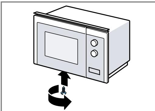
4. Desfiletați cele 2 șuruburi exterioare ale bazei cuptorului cu microunde.
