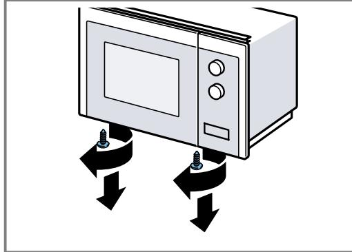
5. Za pomocą dwóch śrub zewnętrznych przymocować ramę montażową do dna kuchenki mikrofalowej.
