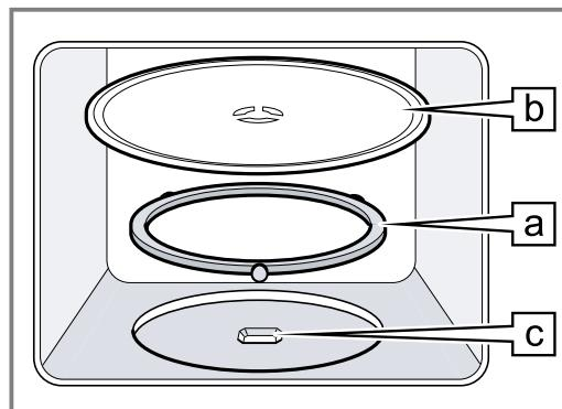
2. Вставьте врачающуюся подставку **b** в приводной механизм **c** посередине дна рабочей камеры.
