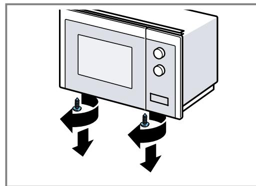
5. Rögzítse a mikrohullámú sütő aján a beépítő keretet a két külső csavarral.
