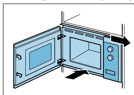
3. Dokręcać urządzenie, aż zostanie wyśrodkowane.
