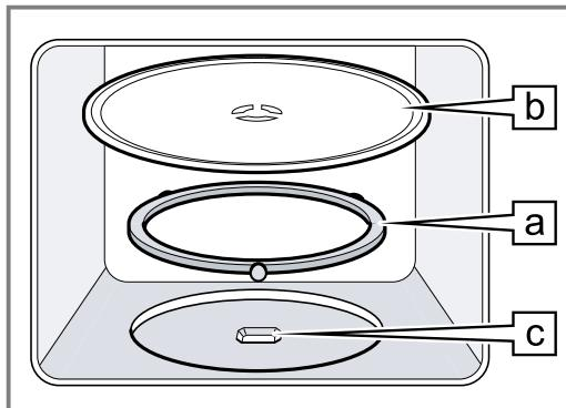
2. Fixați suportul rotativ **b** în piesa de antrenare **c** din centru din spațiul interior al cuptorului.
